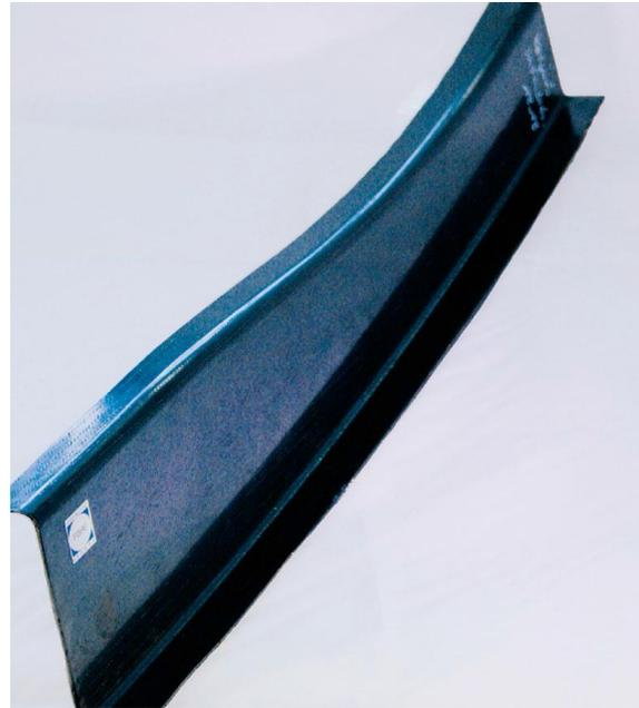
**Bild 5** Mithilfe des Infusionsverfahrens hergestellter Typical-Frame-Abschnitt (© Faserinstitut Bremen)
