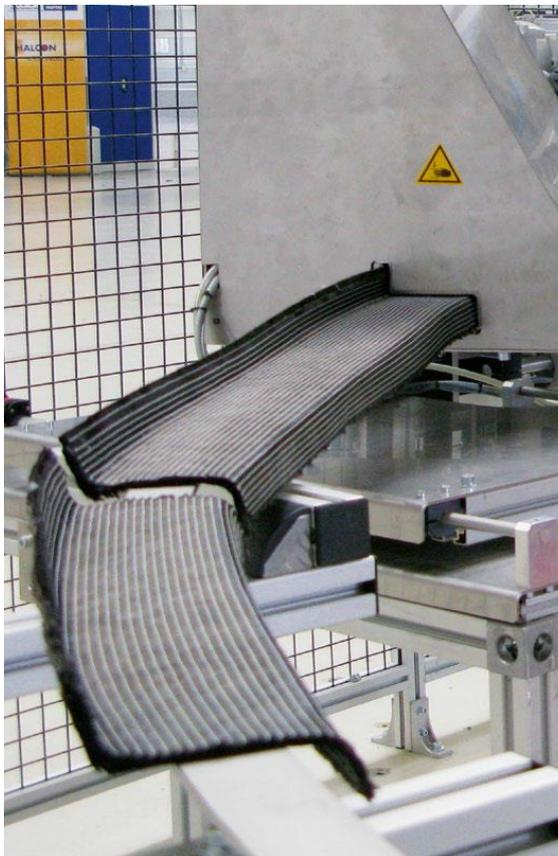
**Bild 3** Preform – kontinuierlich gefertigt mit dem Continuous Composite Preforming System (© Broetje-Automation)
