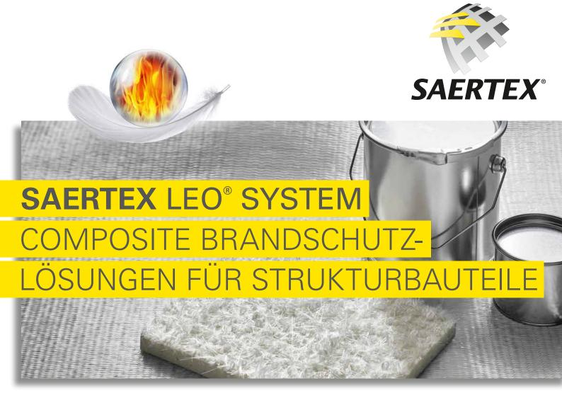
Anforderungsspezifische Systemlösungen mit höchstem Brandschutz, bestehend aus: Gelege, Harz, Gelcoat und optional einem Kernmaterial. Das **SAERTEX** LEO® SYSTEM ist besonders geeignet für strukturelle Bauteile mit komplexen Formen im Bereich Schienenfahrzeuge, Schiffbau und der Baubranche. Hergestellt mittels Vakuuminfusion und RTM.
