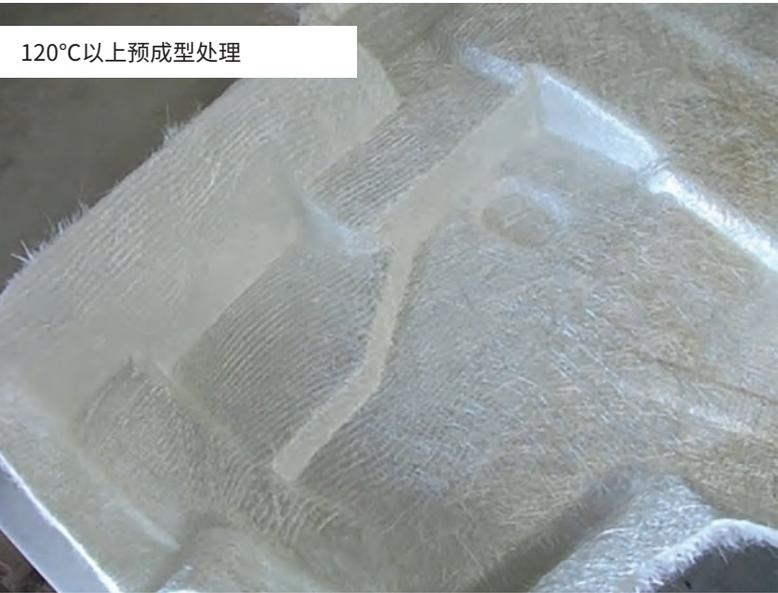
流动特性: 快速导流, 无关真空度
