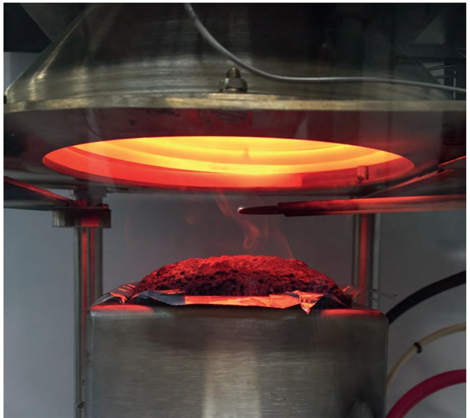
Abb. 5: Cone-Calorimeter-Test gemäß Brandnorm ISO 5660-1
