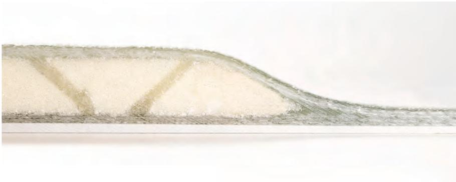
**Abb. 3:** Querschnitt eines LEO-Bauteils mit Sandwichkern
