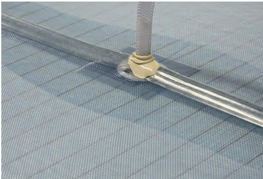
Abb. 1: Imprägnierung mit Harz in der Vakuuminfusion
